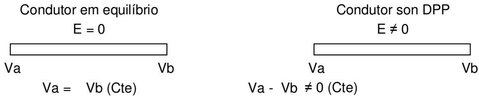
Figura 6: Corrente elétrica em condutor metálico em relação à diferença de potencial
